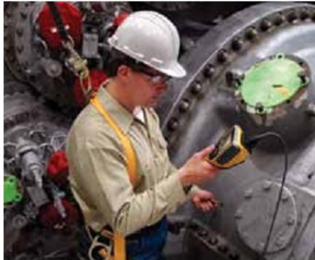
شکل ۲-۲۹- بررسی گسترده توربین گازی با ویدیوپراب XL Go توسط GE.
